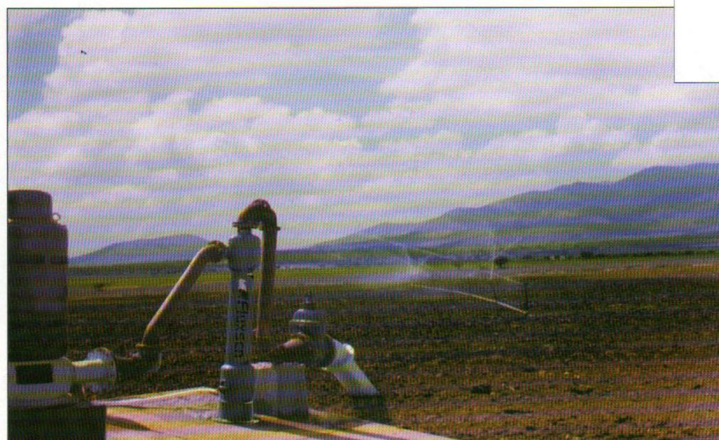
\* Los separadores **Fluxsen** se instalan en la línea de conducción después del equipo de bombeo y funcionan con la presión misma del sistema
